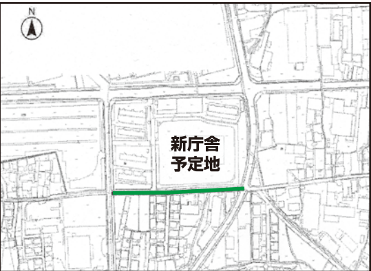
全長約 203 メートルにわたり拡幅・舗装工事を行う
