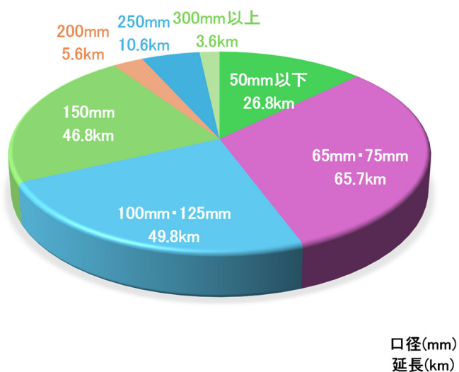
図 2-23 配水管の口径別延長
