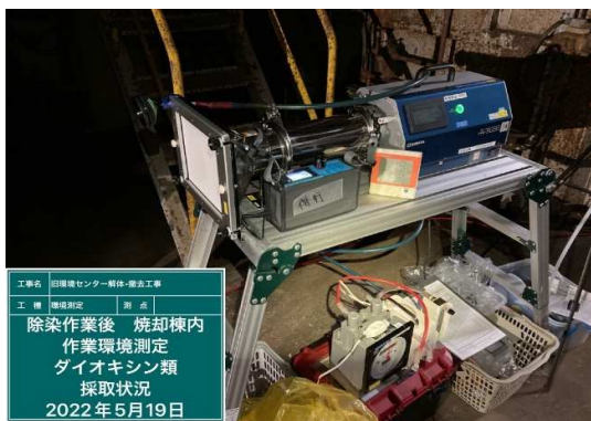
作業環境測定状況
